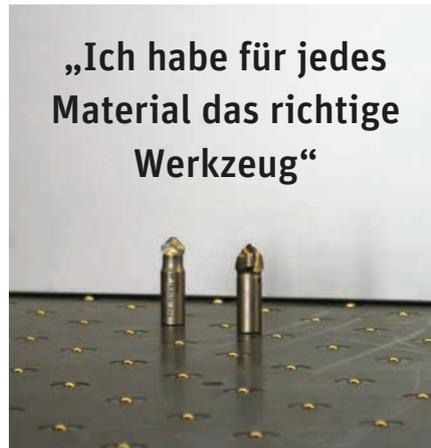
▲ PKD-Fräser zur Fertigung der V-Nuten in Alucobond (Bild: HOB)
