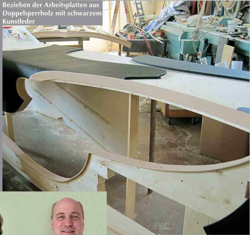
Herstellung der konvexen Rückwand nach 1:1-Skizze
