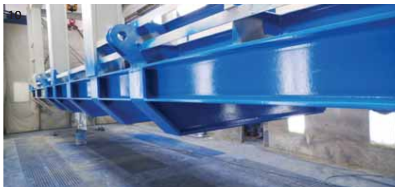
Fig. 9 – Ciclo di verniciatura ecocompatibile qualificato C3-H composto da 90 micron di HYDROGUARD® SZ (primer epossidico idrodiluibile a rapida essiccazione) e da 50 micron di HYDROTHANE® (finitura poliuretanica idrodiluibile). Fig. 10 – Ciclo di verniciatura ecocompatibile qualificato C5M-H, C5I-H e NORSOK M-501 System 7B, composto da 75 micron di HYDROGUARD® Zinc 78 (primer zincante epossidico idrodiluibile a 2 componenti), da 175 micron di HYDROGUARD® HB (intermedio epossidico idrodiluibile ad alto residuo solido) e da 50 micron di HYDROTHANE® (finitura poliuretanica idrodiluibile)
