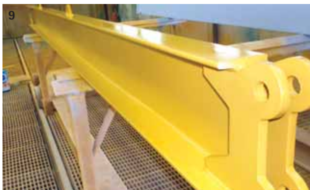
Fig. 9 – Ciclo di verniciatura ecocompatibile qualificato C3-H composto da 90 micron di HYDROGUARD® SZ (primer epossidico idrodiluibile a rapida essiccazione) e da 50 micron di HYDROTHANE® (finitura poliuretanica idrodiluibile). Fig. 10 – Ciclo di verniciatura ecocompatibile qualificato C5M-H, C5I-H e NORSOK M-501 System 7B, composto da 75 micron di HYDROGUARD® Zinc 78 (primer zincante epossidico idrodiluibile a 2 componenti), da 175 micron di HYDROGUARD® HB (intermedio epossidico idrodiluibile ad alto residuo solido) e da 50 micron di HYDROTHANE® (finitura poliuretanica idrodiluibile)
