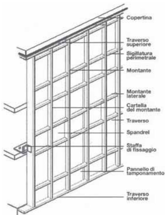
Fig. 1 - Schema componenti facciata M/T
