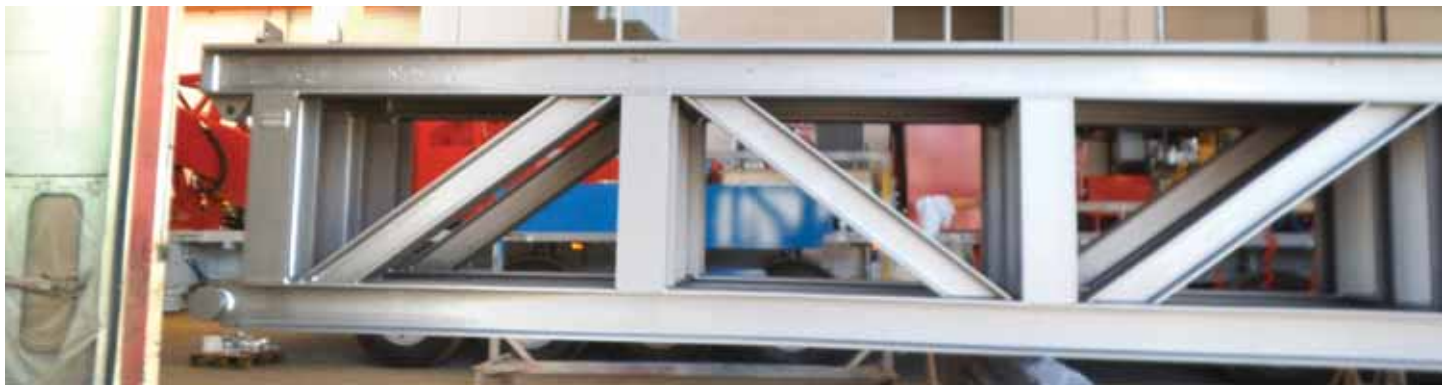
Fig. 8 - Carpenteria sgrassata e preparata al grado Sa2,5
