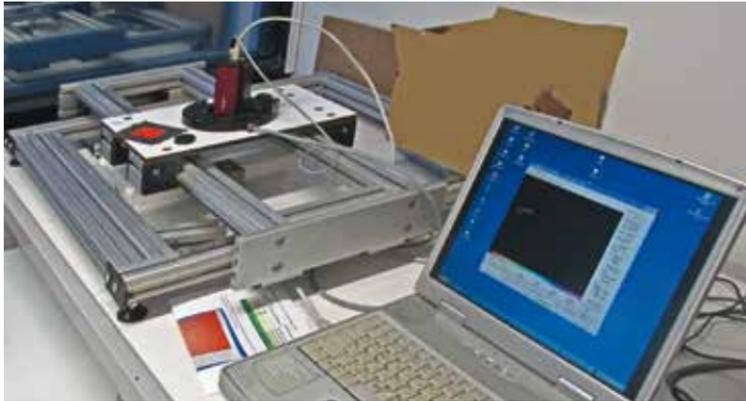
Puls-Amplituden-modulierte-Fotometrie (PAM-Messung) mit Geräten und Software von WALZ
