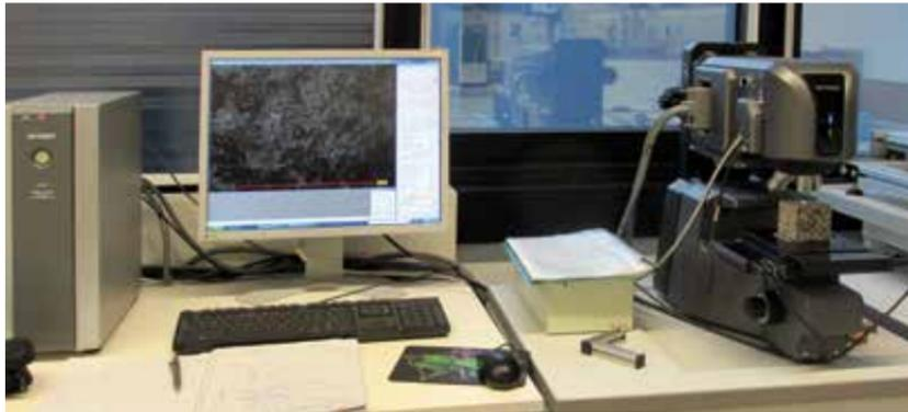
Messung der Oberflächenrauheit mit einem Kayence-Laserscan-Mikroskop
