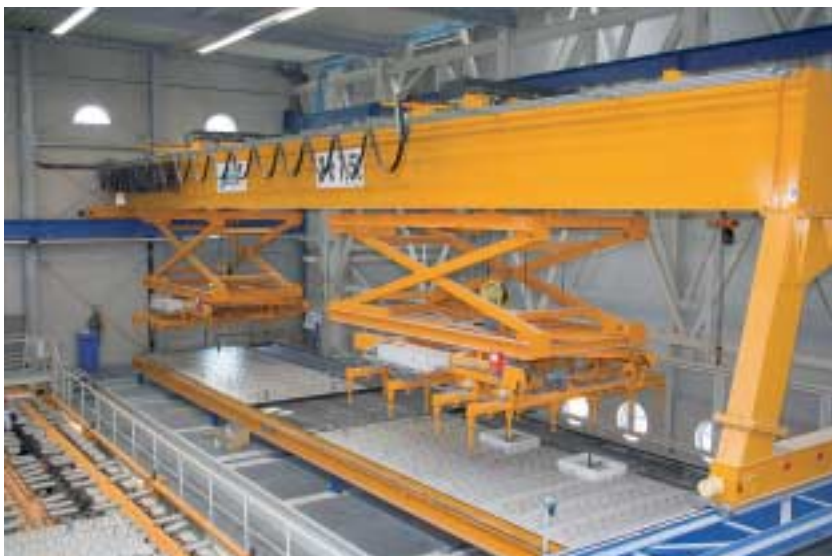
Fig. 9 A special lifting device was designed for this unit: The system includes two lifting scissors fitted with four crossbars each. In turn, five load hooks are attached to each of these crossbars. Abb. 9 Für die Anlage wurde ein spezielles Abhebegerät konzipiert: das System ist mit zwei Hubscheren mit je vier Traversen mit je fünf Lasthaken ausgestattet.
