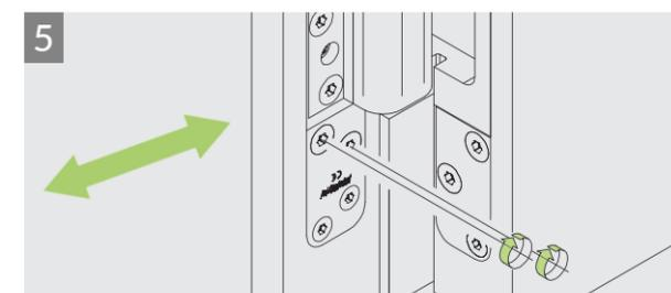
Anpressdruck der Dichtung: Das Band in die gewünschte Richtung (+/- 1 mm) schieben, die Verzahnung hält das Türblatt in der Höhenlage. Die Justierschrauben im Zargenteil des Bandes komplett festziehen.
