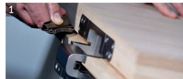
Nach Verschraubung des Bandes im Flügel wird die Flügel dichtung eingebracht. Sie wird im Band mit Hilfe der Dichtungs nut aufgenommen und im Gelenkbereich durch eine bandeigene Dichtung fortgeführt.
