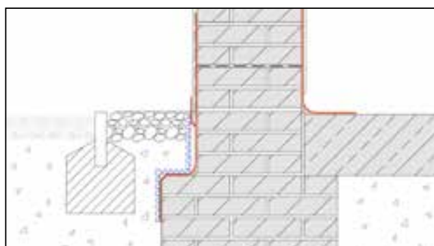
Einschaliges Mauerwerk, feuchte- und salzbelastet
