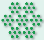
Seil 6 x 7 + WC für Webnet-Seil-Ø 1,0 mm, 1,5 mm und 2,0 mm
