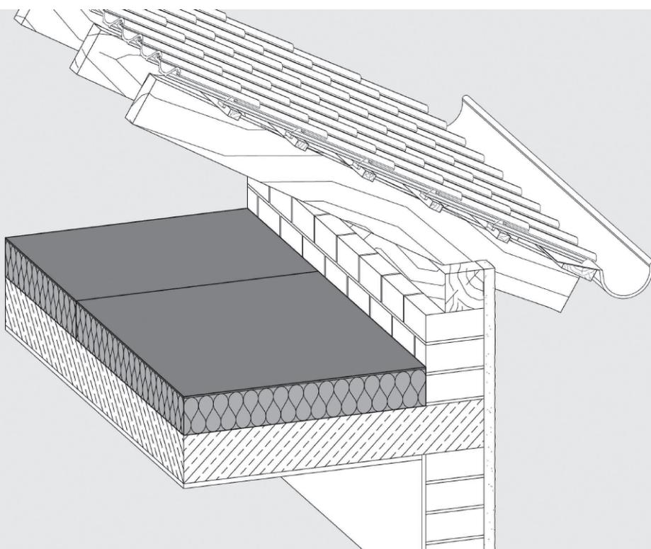
Formstabile, druckbelastbare Steinwolle-Dämmplatte mit lastverteilernder Beschichtung. Die Beschichtung erhöht in besonderem Maße die Widerstandsfähigkeit gegenüber mechanischen Beanspruchungen.
