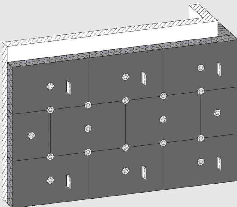
Formstabile Fassadendämmplatte aus Steinwolle mit einseitiger schwarzer Vlieskaschierung für die Dämmung von vorgehängten hinterlüfteten Fassaden.
