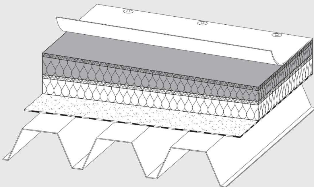
Hoch wärmedämmende, keilförmige Steinwolle-Dämmplatte mit integrierter Zweischichtcharakteristik, die werkseitig mit 2 % Standardgefälle hergestellt ist. (Sondergefälle von 1 % und 3 % sind auf Anfrage möglich.)
