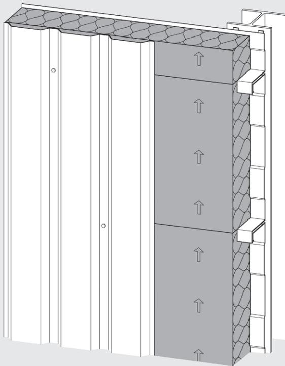
Kunstharzgebundene Steinwolle-Dämmplatte für das Steelrock Plus Kassettenwand-Dämmsystem mit längsseitiger Aussparung zur Aufnahme des Kassettengurts. Die Außenseite und die Einbaurichtung sind durch eine Markierung gekennzeichnet. Steelrock 040 Plus ist elastisch und passt sich fugenlos der Konstruktion an.
