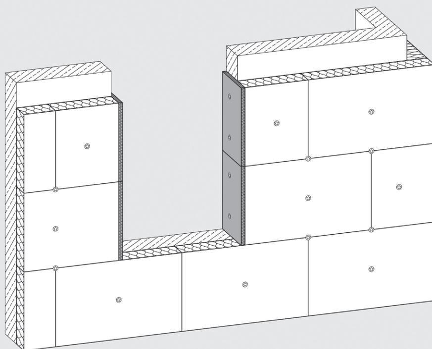
Formstabile Laibungsplatte aus Steinwolle für die Dämmung von Fenster- und Türleibungen in vorgehängten hinterlüfteten Fassaden mit einseitiger, schwarzer Vlieskaschierung.
