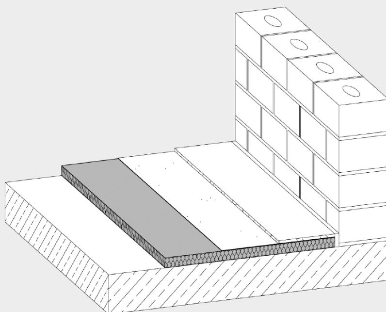
Druckfeste Steinwolle-Dämmplatte für die Wärme- und Trittschalldämmung von Decken unter Estrichen aus Estrichmörteln/-massen auf Dämmschicht.
