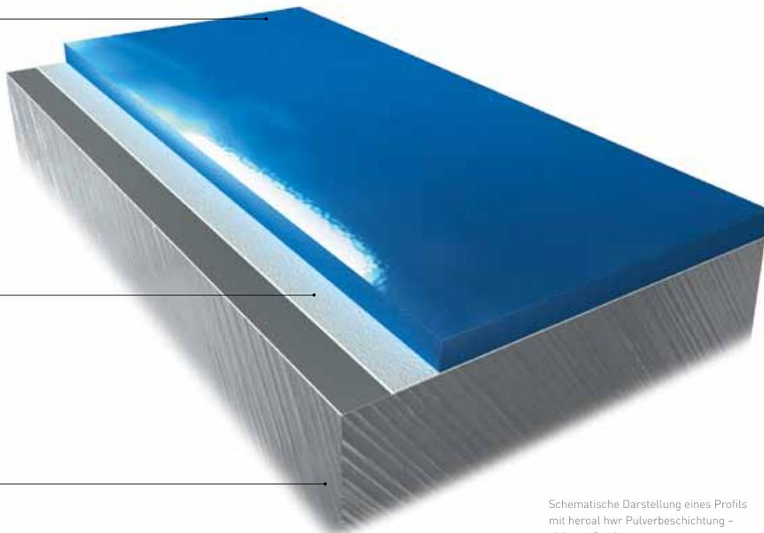
Schematische Darstellung eines Profils mit heroal hwr Pulverbeschichtung – nicht maßstabsgetreu.
