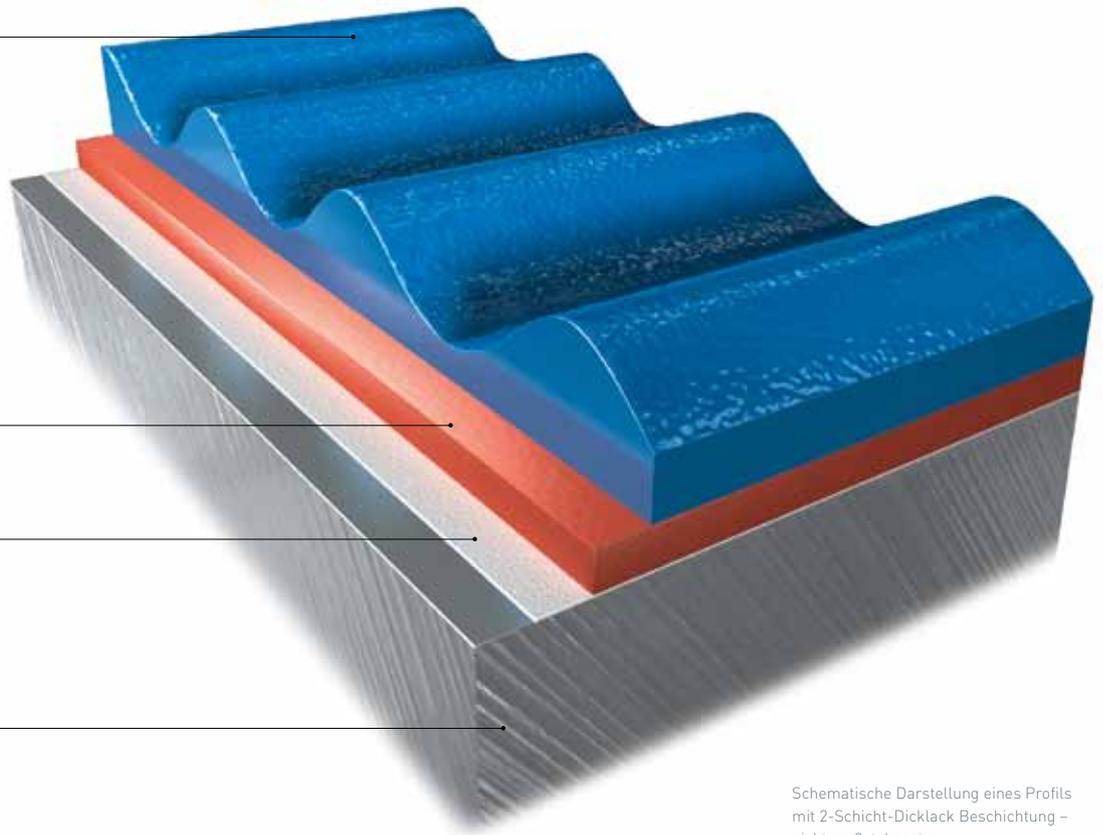
Schematische Darstellung eines Profils mit 2-Schicht-Dicklack Beschichtung – nicht maßstabsgetreu.
