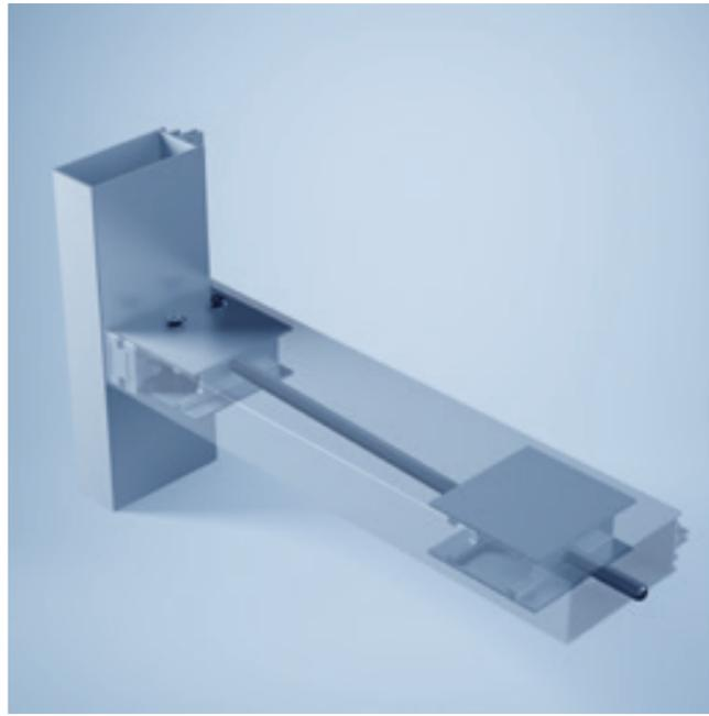
Das Riegel-Spann-System von heroal wird unsichtbar innerhalb eines Hohlprofils montiert und baut eine Vorspannung auf, die den zu erwartenden Lasten entgegenwirkt und das Profil aussteift. Diese Vorspannung des Profils kann individuell auf die zu erwartenden Nutz- und Gebrauchslasten eingestellt werden. Zusätzlich können durch den Einsatz von Schwerlastträgern nochmals die Glasgewichte erhöht werden – so können bis zu 800 kg in einer 50 mm Konstruktion abgetragen werden.
