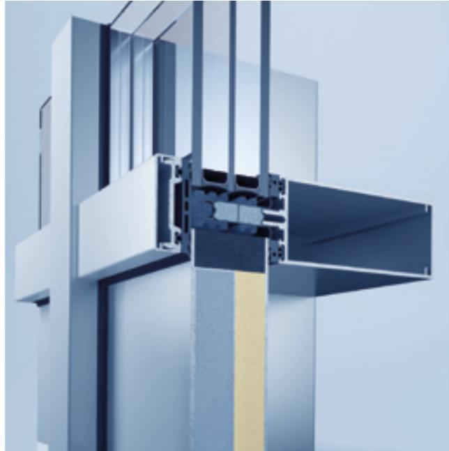
heroal C 50 PH ist die Weiterentwicklung des bereits hochwärmegedämmten Fasadensystems heroal C 50 HI. In der Pfosten-Riegel-Ausführung können minimale  $U_f$ -Werte von  $0,78 \text{ W/m}^2\text{K}$  erzielt werden und mit geeignetem Fassadenpaneel und Verglasung ist das System passivhauszertifiziert. Die modulare heroal Dämmzone reduziert durch den Einsatz innovativer Werkstoffe und Materialien den Energieverlust auf ein Minimum.
