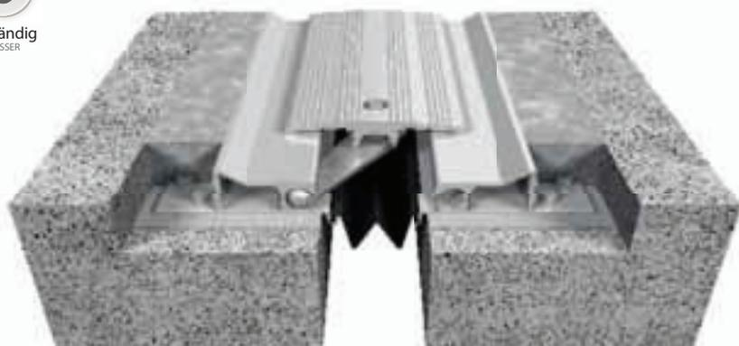
\* **EPDM-Dichtung:** Folienförmige Dichtung aus Ethylen-Propylen-Dien-(Monomer)-Kautschuck, ein gummi-elastischer Werkstoff nach DIN 13956. Bis zu 500% dehnbar | Dauerhaft elastisch (zwischen -40°C und + 120°C) | jahrzehntelange Lebenserwartung alterungs- und ozonbeständig | UV- und IR-stabil | widerstandsfähig gegen viele chemische Substanzen.
