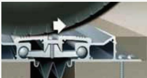
Eine besondere Profilausbildung mit einem starken Guss-Scherenmechanismus überträgt die Kraft der Fahrzeuge auf den Untergrund ohne den mittleren Befestigungsbolzen zu beschädigen.
