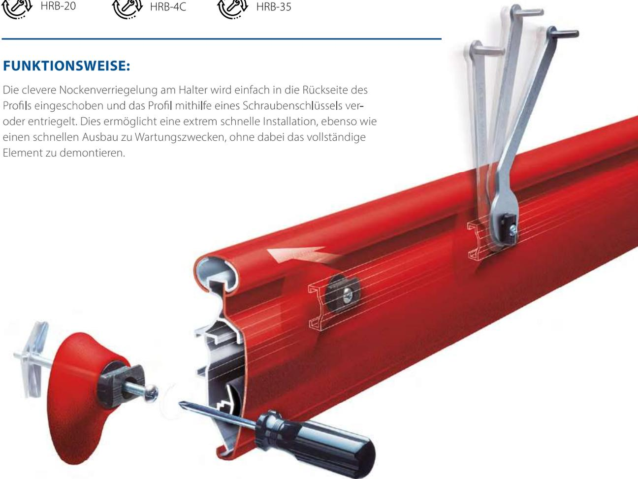
HRB-20 & HRB-35-Profile verfügen über Quick-Lock-Endstücke, die eine schnelle Montage der Halterung ermöglichen, ohne dass Befestigungslöcher für die Endstücke gebohrt werden müssen.
