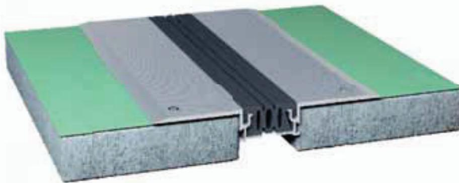
\* **EPDM-Dichtung:** Folienförmige Dichtung aus Ethylen-Propylen-Dien-(Monomer)-Kautschuck, ein gummi-elastischer Werkstoff nach DIN 13956. Bis zu 500% dehnbar | Dauerhaft elastisch (zwischen -40°C und + 120°C) | jahrzehntelange Lebenserwartung alterungs- und ozonbeständig | UV- und IR-stabil | widerstandsfähig gegen viele chemische Substanzen.
