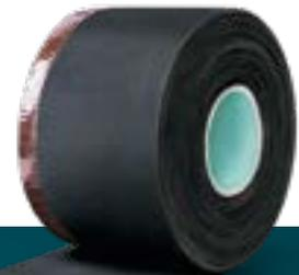
Hanno®-Folienband EPDM ist eine zweischichtige, elastomere Abdichtungsbahn. Es ist besonders geeignet für die elastische Abdichtung von Fenster- und Fassadenanschlüssen im Außenbereich, zur Ausführung der Baukörperanschlussfuge bei Fensterbänken und Balkon- und Haustüren im nicht erdberührenden Anschlussbereich mit einer Dicke von 0,75 mm.
