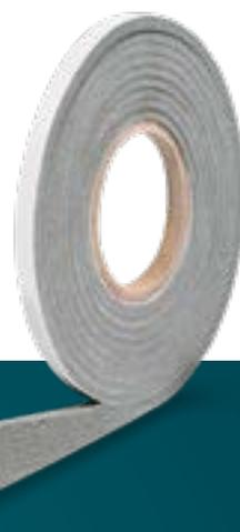
Fugendichtungsband mit speziell auf den Brandschutz eingestellter Acrylat-Dispersionsimprägnierung. Dieses spezielle Brandschutzband ist schwer entflammbar gemäß DIN 4102 und einsetzbar bis zur Feuerwiderstandsklasse EI 120<sup>1</sup>, gemäß EN 1366-4. Bestätigt durch Systemprüfungen<sup>2</sup>.
