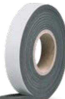
Hannoband®-600 wird universell für die Fugenabdichtung im Hochbau eingesetzt. Bevorzugtes Einsatzgebiet ist die Abdichtung von Fensterfugen; darüber hinaus wird es im Holzbau, Fertigungsbau und Mauerwerksbau, Fachwerkbau und Betonbau verwendet.
