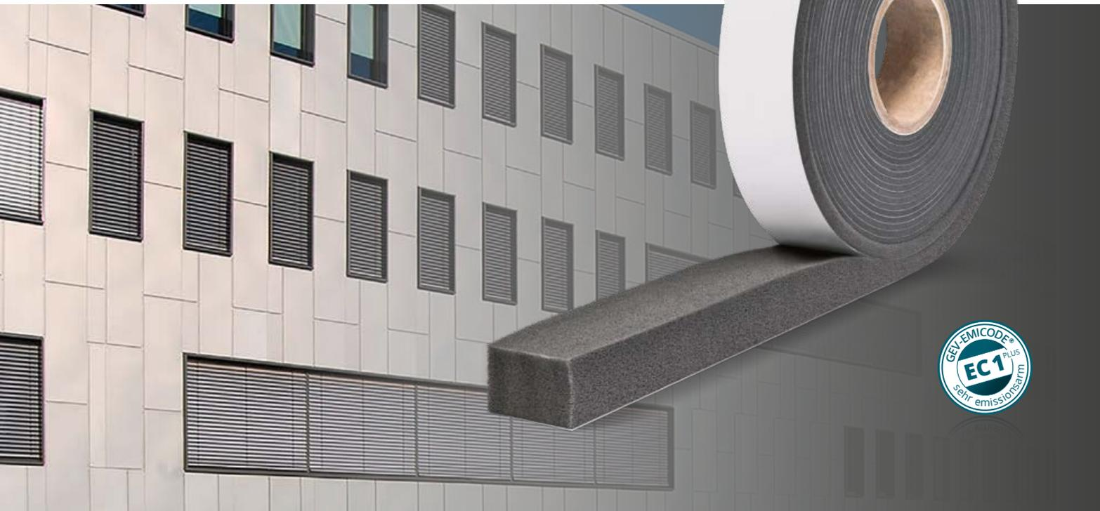
Für Unterputzanwendungen – kostengünstiger Schutz vor Zugluft, Staub, Flugschnee, Feuchtigkeit und Lärm mit hervorragender Wärmedämmung. Schlagregensicherheit von  $> 300$  Pa und Luftdichtheit von  $a_n < 1,0$  hängen von der Kompressionsrate des Schaumstoffs ab. Dieses Dichtungsband ist ideal für die Abdichtung von großen Fugen bis 40 mm Breite und ist erhältlich ab einer Schnittbreite von 30 mm, sodass für jede Bausituation das richtige Band zur Verfügung steht.
