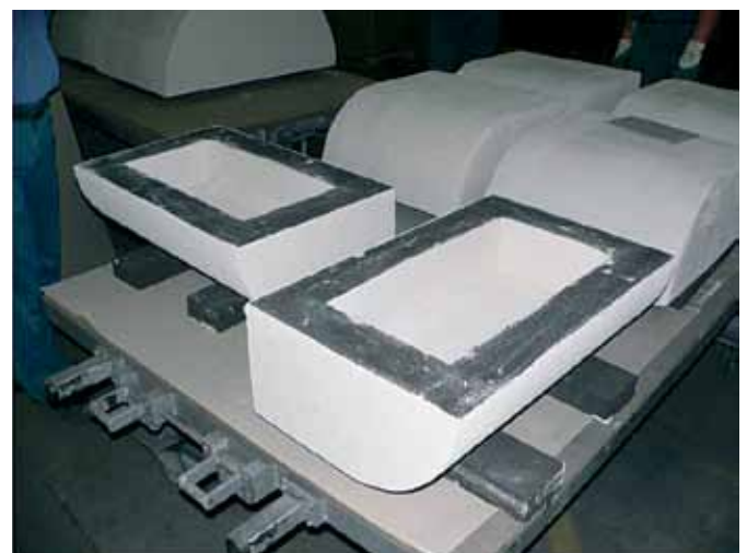
Vorgefertigte Ventilkappen aus FOAMGLAS® für Thermalölanlage.
