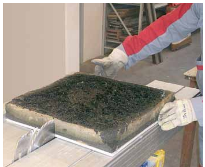
Melt Shield-Effekt: Hitzeeintrag wird durch die Oberflächenveränderung der Dämmplatte eingeschränkt. Plattenstruktur FOAMGLAS® bleibt nach thermischer Belastung erhalten.
