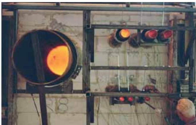
Versuchsaufbau R 90/ R 120-Prüfung Brandwanddurchführung
