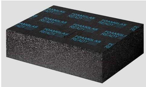
FOAMGLAS® READY TAPERED T4+ besteht aus FOAMGLAS® READY T4+, welches entlang der Quer- bzw. Längsachse ein Gefälle aufweist. Ein Pfeil zeigt die Richtung des Gefälles an. Oberseitig ist eine PE-Folienkaschierung aufgebracht. Diese ist zum Aufschweißen von Bitumenbahnen geeignet.
