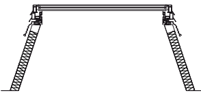
Kingspan ESSMANN Flachdachfenster mit 3-fach Wärmeschutzverglasung im Querschnitt
