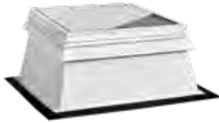
Kingspan ESSMANN Flachdachfenster mit vertikalem thermisch getrennten Stahl-Aufsetzkranz 50 cm und 6° Neigung
