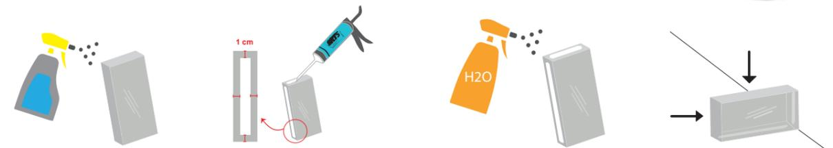
**1** Reinigen Sie vor der Verklebung alle Klebeflächen der Glasziegel mit dem SRT5 Montagespray.
