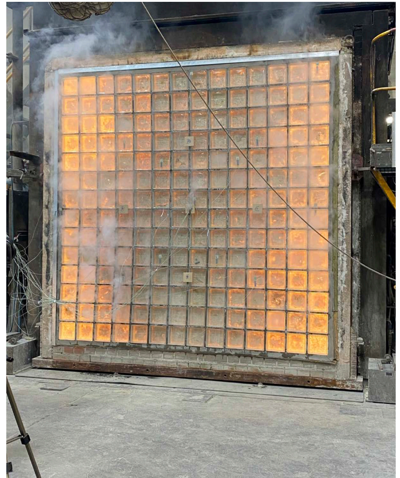
Brandschutztest MPA Materialprüfanstalt für das Bauwesen - Braunschweig 2021
