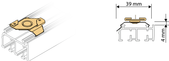
Schnellmontageclip mit Halteclip gekröpft für T-Profil 24–26 mm, nur geeignet für Schiene 7620 und 7630
