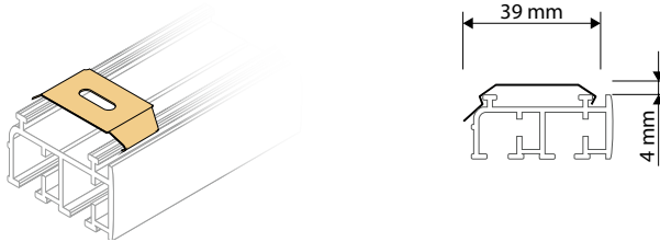
Halteclip gekröpft mit Langloch für 2- / 3- Lauf Schiene
