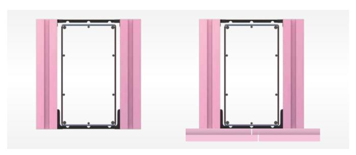
Je nach Planung kann eine Fundamentschalung mit gedämmten Boden von Nöten sein. Auch in diesem Fall sind Sie mit der Easy Klick Fundamentschalung bestens aufgestellt.
