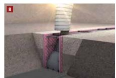
Gegebenenfalls muss die Schalung beim Betonieren weiter mit Erdreich angefüllt werden.
