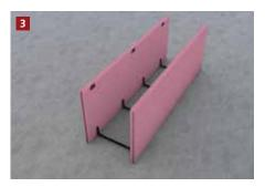
Die Distanzstücke werden in die Aufnahmewinkel eingeklickt. Das Distanzstück kann individuell abgelängt werden.
