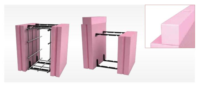
Der Dämmstoff XPS verhindert wirksam die Kälteeinleitung durch das Fundament. Komplett vorgefertigt mit platzsparend beigelegten Distanzstücken passend zur gewünschten Fundamentbreite. Die obere Abspannung mit Montageplatte inkl. Aufnahmeelement erleichtert den Einbau der Bewehrung enorm.
