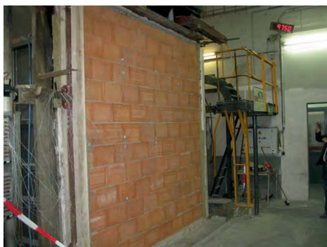
Bild 11: Brandwand aus PHLzB nach der Prüfung nach DIN EN 1365-1
