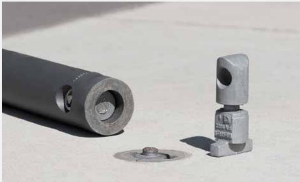
Das austauschbare Verbindungsstück bricht an der **Sollbruchstelle**. Poller und Fundament mit Bodenhülse bleiben in aller Regel unversehrt.
