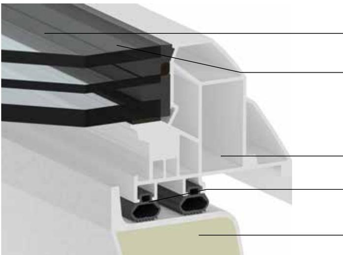
Erstes Flachdach Fenster mit allgemeiner bauaufsichtlicher Zulassung in **Structural-Glazing-Bauweise**
