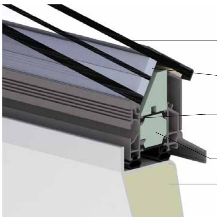
**Wärme- oder Sonnenschutzisolierverglasung** mit Stufenfalzverglasung
