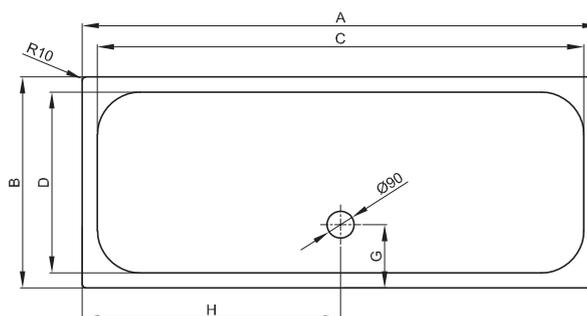
Die Duschwannen ab einer Schenkellänge 1600 mm werden mit einem Mittelablauf auf der langen Seite geliefert.
