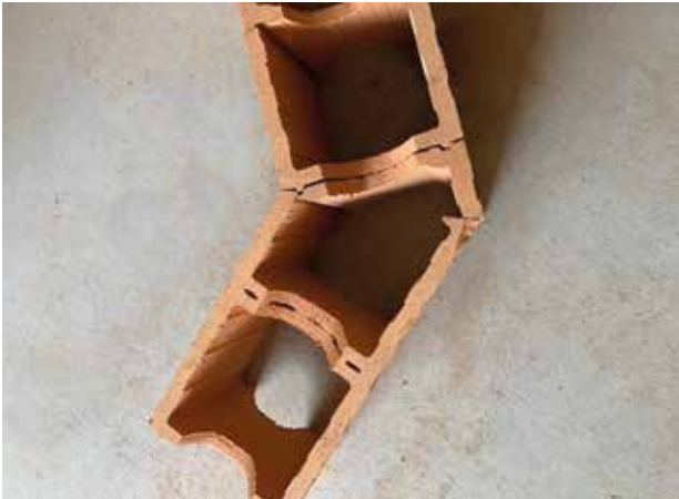
Variante 1: 45-Grad-Ecke mit zugeschnittenem S-Sz®
