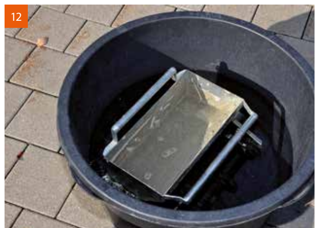
12 Nach Arbeitsende wird die V.D-Mörtelrolle gründlich mit Wasser gereinigt.
