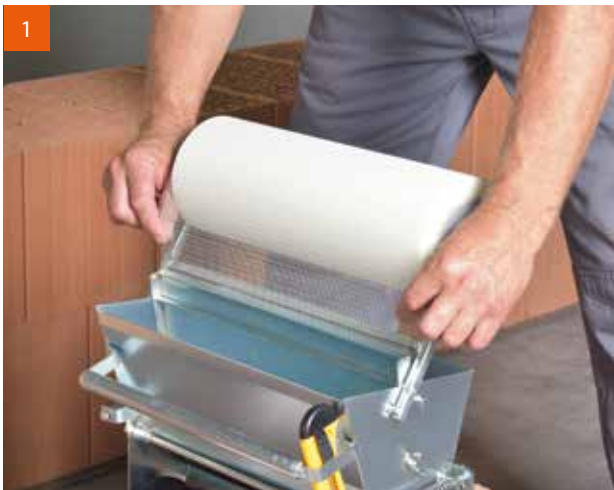
1 Einlegen des Gewebes in die V.Plus®-Walze. Das Glasfilamentgewebe wird in ausreichender Menge mitgeliefert.
