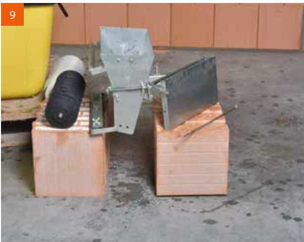
9 Nach Arbeitsende kann die V.Plus®-Walze einfach in Einzelteile zerlegt und gründlich mit Wasser gereinigt werden.
