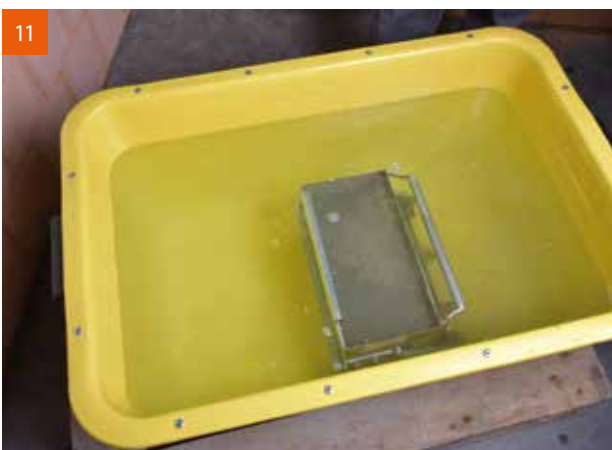
11 In längeren Arbeitspausen empfiehlt es sich, die Rolle im Wasserbad zu lagern, um ein Austrocknen des Mörtels zu verhindern.
