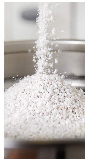
Das Volumen wächst enorm! Wenn man Perlit aufbläht, ist es hinterher bis zu zwanzig Mal größer als zuvor.
