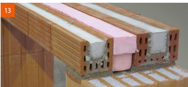
Ausbildung von Fenster- und Türstürzen mit Einlegen einer Wärmedämmung WLG 035, d \geq 7,0 cm, Sturzhöhe 11,3 cm.
