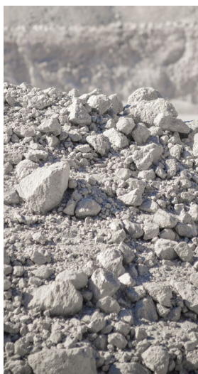
Perlit enthält einen Anteil an fest gebundenem Wasser.
