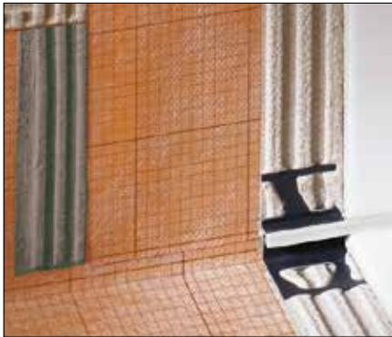
Schlüter-KERDI ist eine rissüberbrückende Abdichtungsbahn aus weich eingestelltem Polyethylen, beidseitig versehen mit einem speziellen Vliesgewebe zur wirksamen Verankerung im Fliesenkleber. Schlüter-KERDI wurde als Abdichtung im Verbund mit Bekleidungen und Belägen aus Fliesen und Platten entwickelt.
