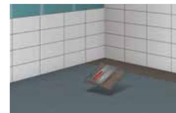
11 Auftragen einer Kontaktschicht bei größeren Formaten
