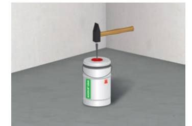
4 Durchstechen des Deckels mit Härterinhalt
