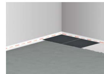
9 Verlegen der Bodenkeramik
