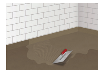
9 Auftrag der 2. Abdichtungsschicht
