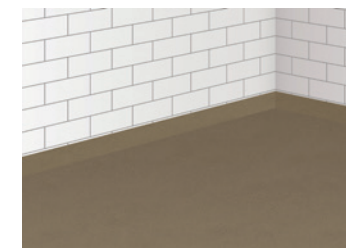
8 1. Abdichtungsschicht trocknen lassen
