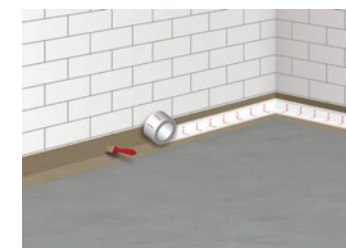
6 Verkleben der ASO-Dichtbandtechnik in den 1. Auftrag der Abdichtungsschicht
