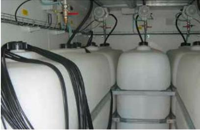
Lagerung und Dosierung flüssiger Betonzusatzmittel im Betonwerk
