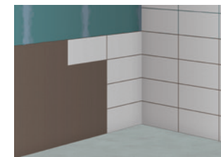
7 Verlegen der Wandkeramik
