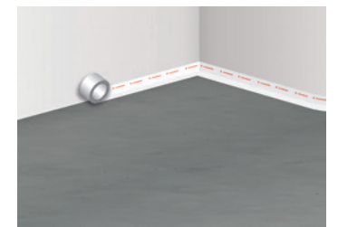
2 Stellen eines Randdämmstreifens mit RD-SK50
