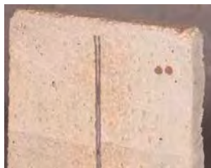
Verbund zweier AQUAFIN-CJ5 Bleche im Betonquerschnitt.
