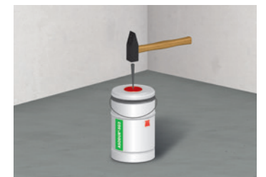
4 Durchstoßen des Deckels mit eingefüllter Härterkomponente
