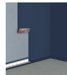
9 Auftrag der 1. Abdichtungsschicht (Dichtschicht)
