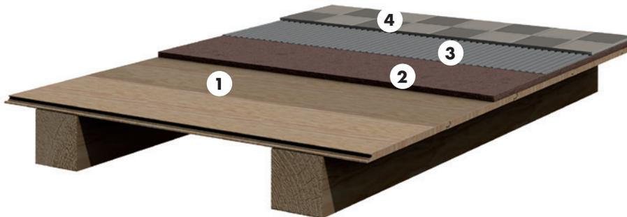
Eine besonders schnelle, leichte und wasserfreie Lösung für gleichzeitigen Ausgleich von Untergründen bietet der Epoxidharz-Leichtestrich ASODUR-LE. Bei der Verlegung von Großformaten über eine Kantenlänge von 40 cm und einer Fläche von 0,18 m<sup>2</sup> empfehlen wir folgenden Konstruktionsaufbau:
