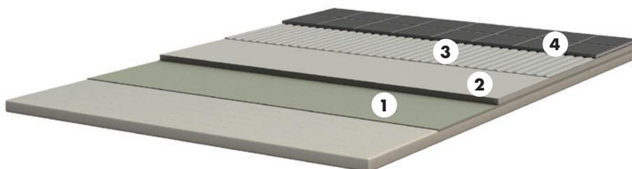
Der Direktkontakt zwischen zementärem Fliesenmörtel und Magnesitestrich führt zu der Zerstörung des Magnesitestriches durch eine chemische Reaktion, die als Magnesiatreiben bekannt ist. Eine rückwärtige Feuchtigkeitsbelastung aus dem Untergrund muss durch entsprechende Maßnahmen ausgeschlossen sein.
