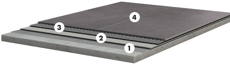
Voraussetzung für das Verlegen von großformatigen Fliesen und Platten ist ein ebenflächiger Untergrund. Je größer die Formate sind, umso ebenflächiger muss der Untergrund sein.
