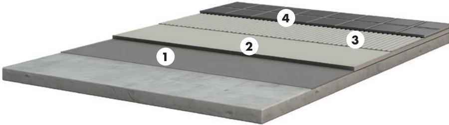
**Bei normaler Restfeuchte:** CA-Fließestriche müssen angeschliffen, abgesaugt und wie alle CA-gebundenen Untergründe mit ASO-Unigrund grundiert werden. Heizestriche müssen vor den Belagsarbeiten nach den anerkannten Regeln
