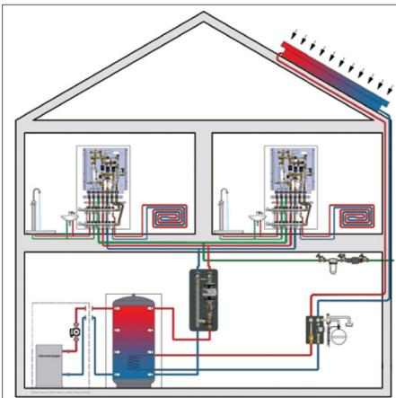
Die Station "Regudis W-HTF" ist eine komplett auf einem Halterungsblech montierte und dichtgeprüfte Einheit mit direktem oder gemischtem Heizkreis.
