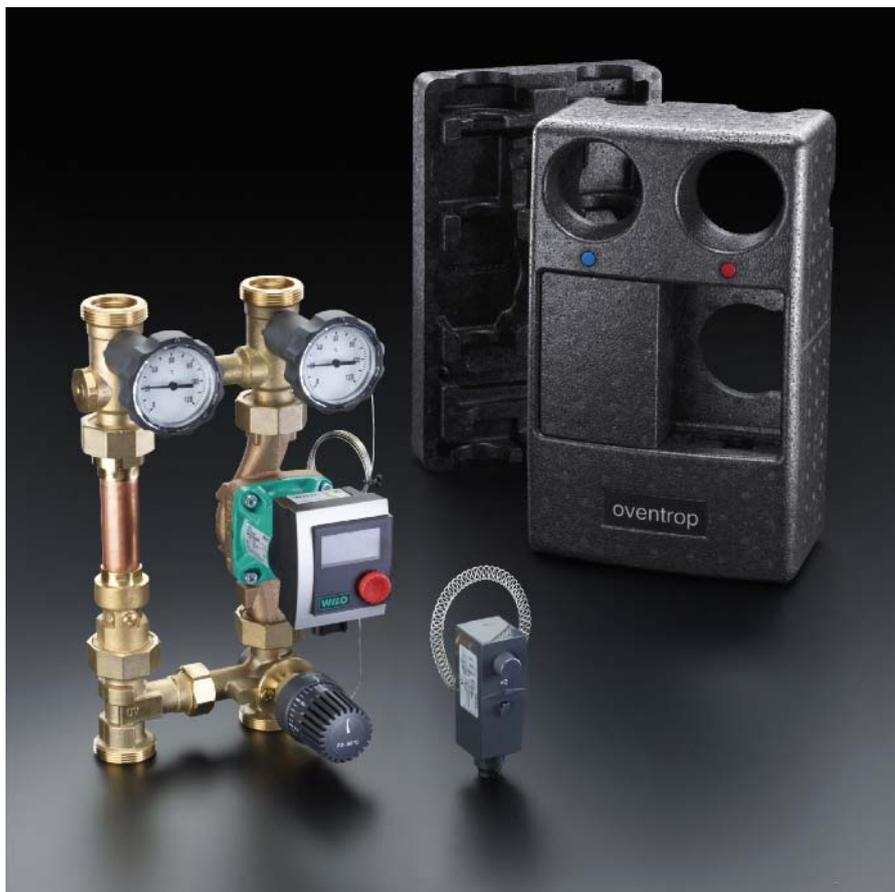
Das Festwertregel-Set „Regumat F/FR-130/180“ ist eine Vorlauftemperaturregelung und Begrenzung für kombinierte Radiator-Fußbodenheizungen. Die Vorlauftemperatur wird in einem Einstellbereich von 20–50 °C geregelt. Die Ausführung „Regumat FR-180“ besitzt ein Pumpengehäuse aus Rotguss, um der Korrosionsgefahr bei systembedingtem Sauerstoffeintrag entgegenzuwirken.
