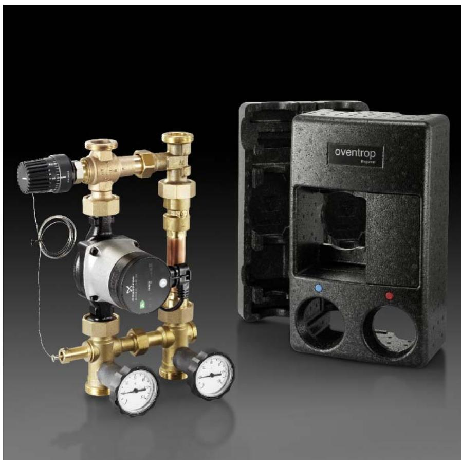
Die „Regumat RTA“ Stationen ermöglicht den Anschluss des Heizsystem/ Speichers an den Holz-Heizkessel. Die Rücklafterperatur zum Holz-Heizkessel liegt min. bei 55 °C und somit oberhalb des Taupunktes. Sie verhindert die Kondensat-Teerbildung. Im Anfahrbetrieb läuft der Kesselkreis im Kurzschluss, über den Bypass wird dem Rücklauf heißes Vorlaufwasser zugeführt. Nach Erreichen der Rücklafterperatur von 55 °C öffnet das Mischventil.
