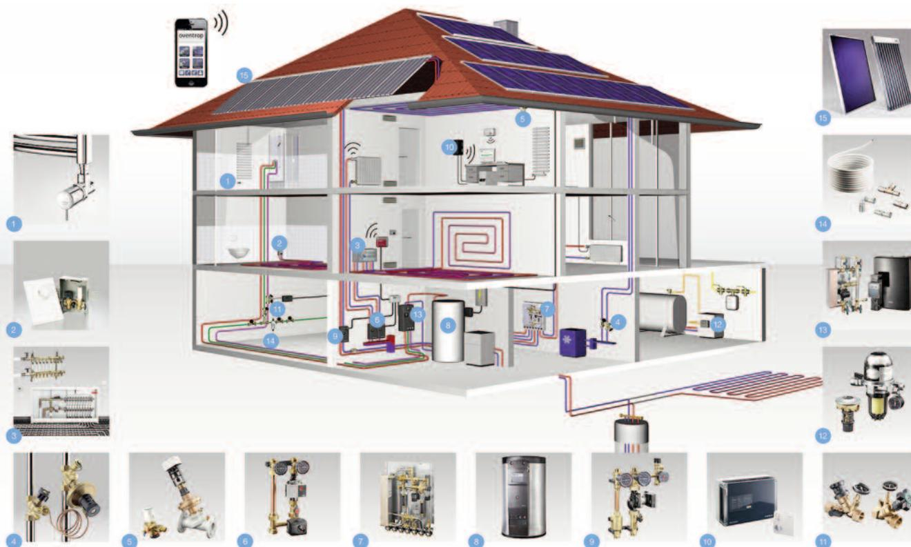
Vielfalt und Bauformen der Oventrop Armaturen und Thermostate helfen dem Großhandel, Installateur und Planer armaturentechnische Anforderungen zu erfüllen. Sie ermöglichen durch ihre Voreinstellung eine hydraulische Anpassung der Heizwassermenge und damit eine wirtschaftliche Wärmeabgabe der einzelnen Heizkörper.
