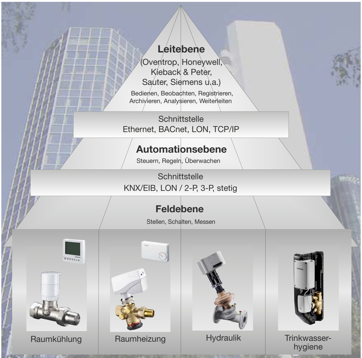
Übersicht Gebäudeautomation und Systemkomponenten
